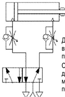
Дросселируется поток, вытесняемый из полости пневмоцилиндра. Обеспечивается равномерное движение поршня, в том числе на малых скоростях и при переменной нагрузке.
