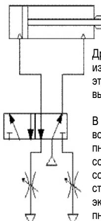
Дросселируется поток, вытесняемый из полости пневмоцилиндра. При этом дроссели установлены в портах выхлопа пневмораспределителя.
