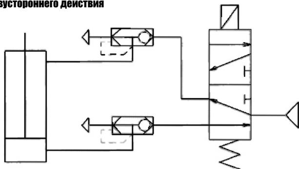
Вытесняемый из полости пневмоцилиндра воздух истекает наружу через клапан быстрого выхлопа. В результате сопротивление движению поршня снижается до минимума, что позволяет обеспечить максимально возможную скорость поршня. Схема наиболее эффективна, когда клапаны максимально приближены к пневмоцилинду.
