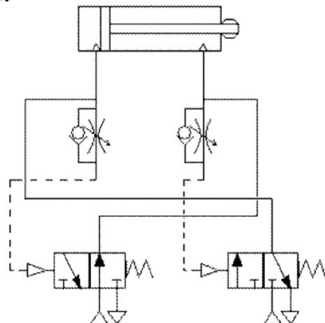
Надежная автоколебательная система с возможностью регулировки частоты и скважности.
