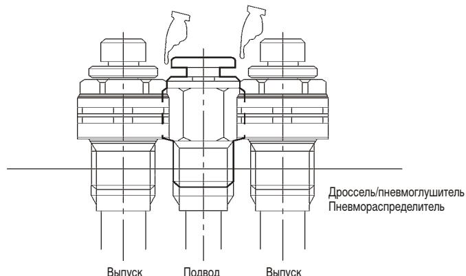
Для удаления пыли, грязи, посторонних частиц необходимо перед началом монтажа продуть сжатым воздухом подсоединяемые к пневмодросселям/обратным клапанам трубопроводы.
